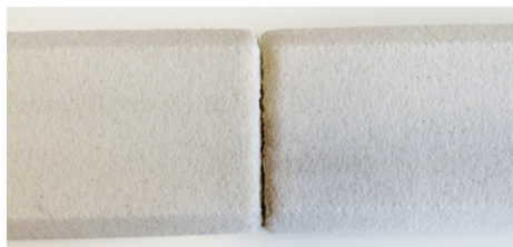
Фабричный стык (так изделие сходит со станка)
