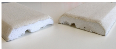
Фабричный стык (так изделие сходит со станка)
